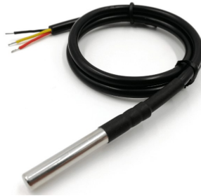
Gambar 4. Sensor Temperatur (DS18B20)
