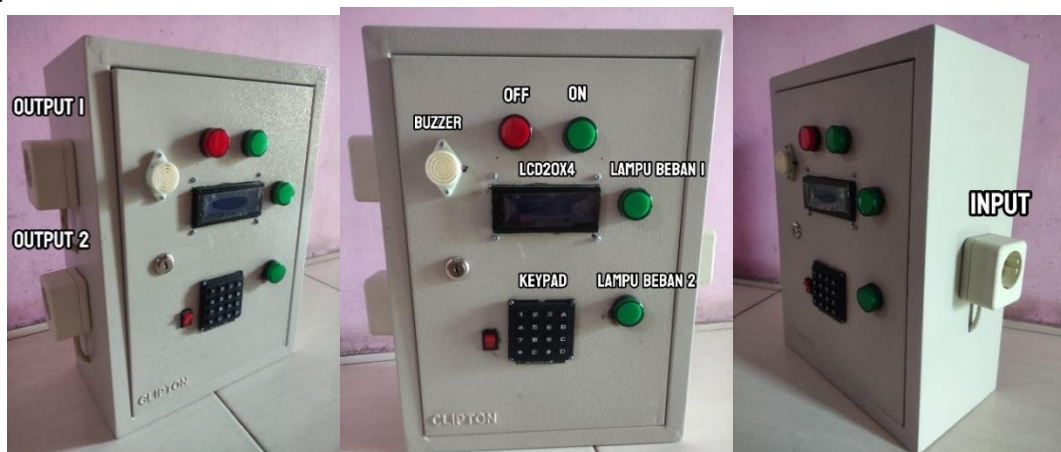
Gambar 3 Bentuk Alat Kontrol dan Monitoring Penggunaan Energi Listrik
