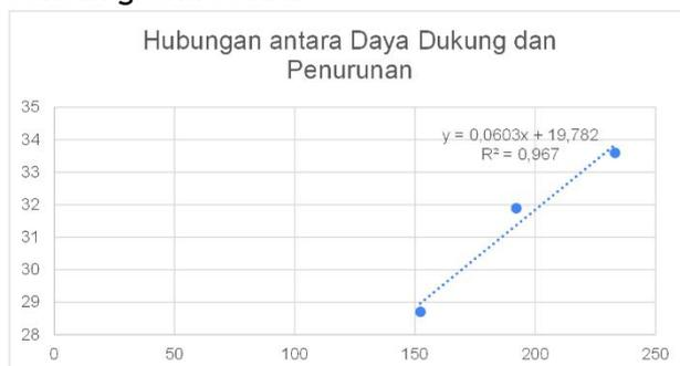
Gambar 2. Grafik Regresi Linier Hubungan antara Daya Dukung dan Penurunan Tiang Pancang
