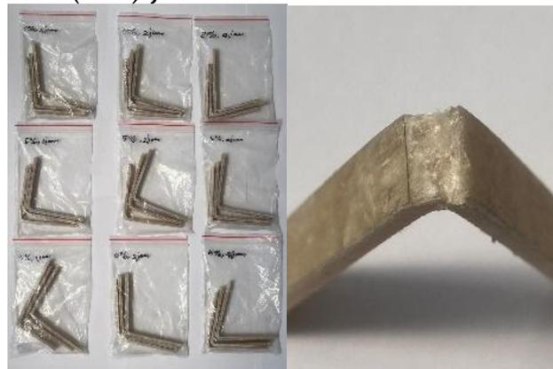
Gambar 5. Spesimen Komposit Serat Daun Nanas yang telah di Uji *Bending*
