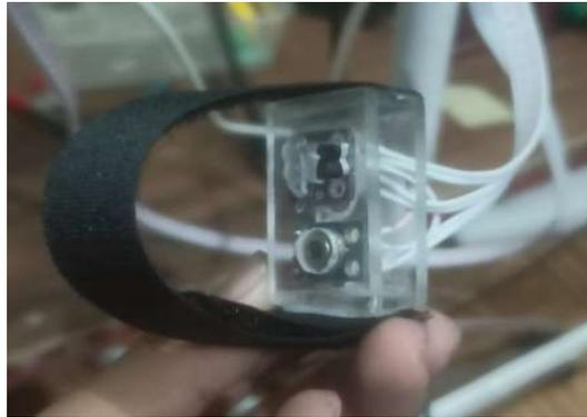
Gambar 8. Hasil Perancangan Sensor MAX 30102 dan Sensor MLX 90614
