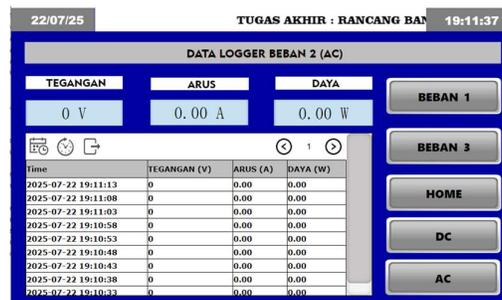
Gambar 8. Tampilan HMI pada Data Logger Beban 2
