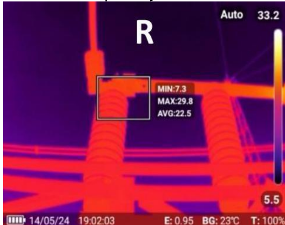
Gambar 3 Hasil Thermovisi Phasa R
