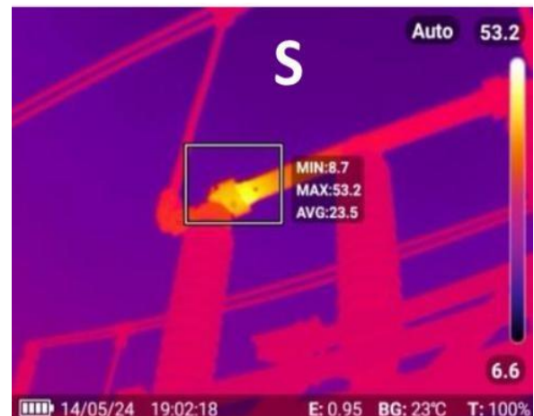
Gambar 4 Hasil Thermovisi Phasa S
