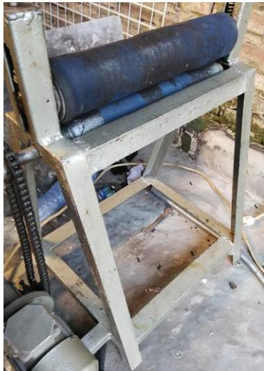
Gambar 2. Alat roller untuk memperkuat sambungan setelah dipress.
