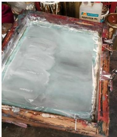
Gambar 3. Meja sablon untuk mencetak logo atau desain pada permukaan sandal.
