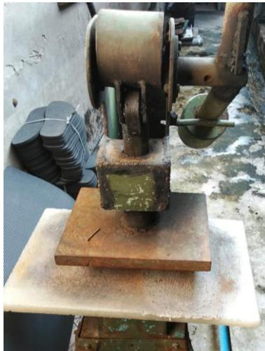
Gambar 5. Mesin benger untuk merapikan tepi sandal setelah dipress.
