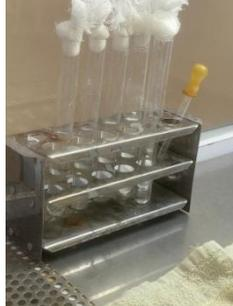
**Gambar 1. Tabung reaksi steril dengan penutup kasa**
