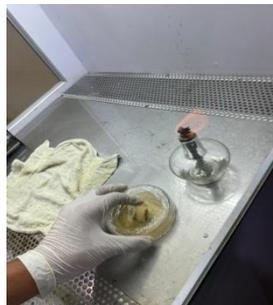
**Gambar 4. Inkolusi sampel air kolam pada media Nutrient Agar (NA) dalam kondisi steril menggunakan Laminar Air Flow dan Lampu spiritus sebagai zona aseptis**
